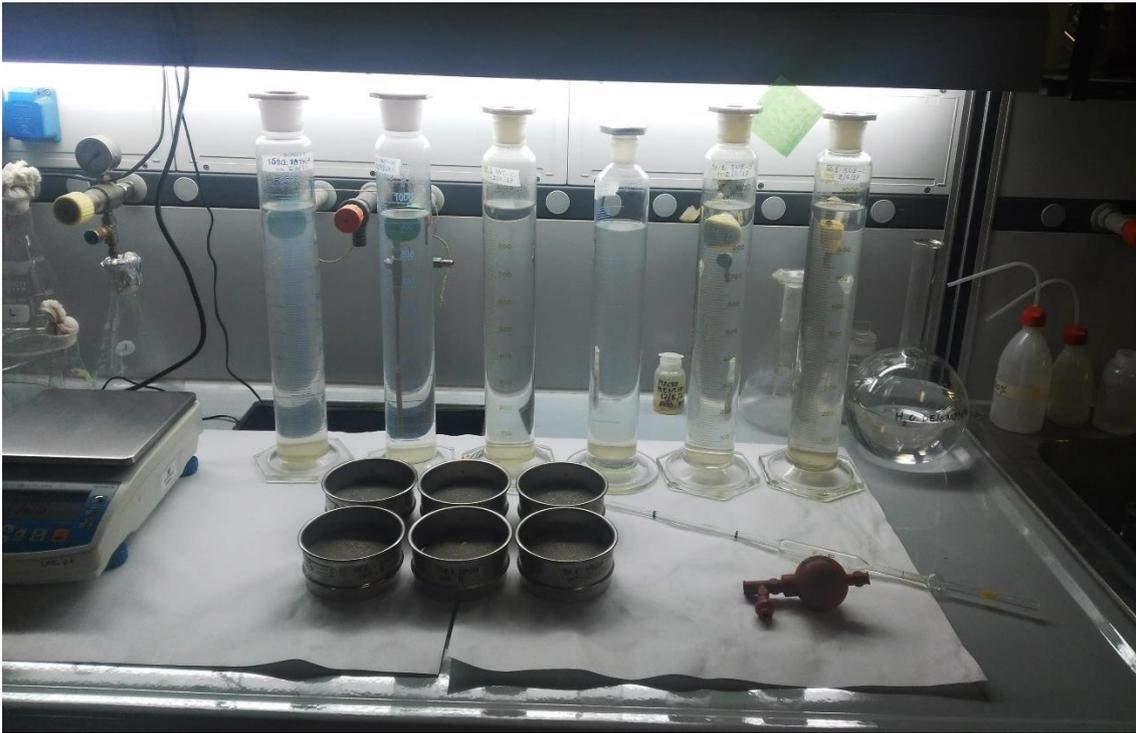
**Figura 21:** Davanti i setacci Endecotts SpA per il frazionamento a secco della componente sabbiosa del sedimento. Dietro i cilindri graduati per la misurazione delle frazioni più fini (silt e argilla).
