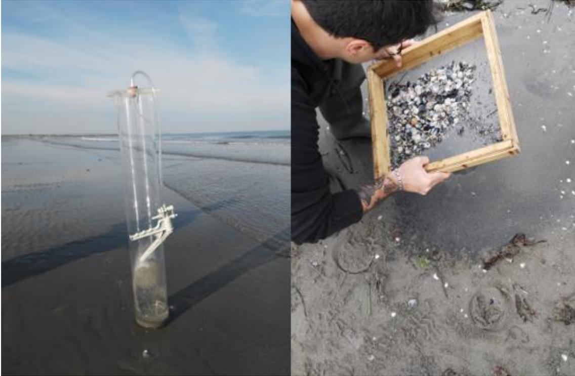
**Figura 9:** Carotatore (sx) e setaccio (dx) utilizzati durante le operazioni sul campo.
