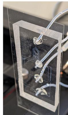
Figura 1.1: Chip microfluidico realizzato durante l'attività di laboratorio.
