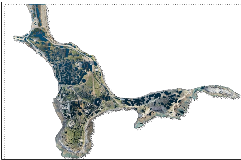
Fig. 23 - La nuvola risultato dell'attività di rimozione dei punti non appartenenti al terreno, come si può vedere una porzione non indifferente del modello è stata rimossa
