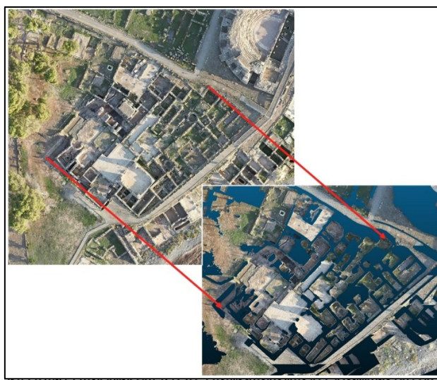
Fig. 12 - In alto una cattura dall'ortofoto del quartiere delle terme centrali, sotto una cattura della medesima area dalla nuvola di punti del DTM
