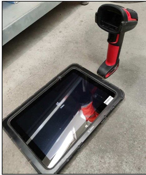
Figura 5.16 Strumento informatico (tablet e lettore di codici a barre) introdotti in magazzino per l'utilizzo del sistema ERP aziendale per la gestione delle locazioni (immagine adattata da fonte interna MEHITS S.p.A.)
