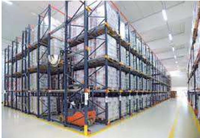
Figura 2.4 Esempio di magazzino drive-in (immagine tratta da www.mecalux.it )
