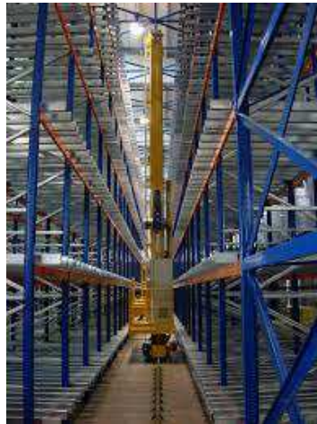
Figura 2.5 Un trasloelevatore nella corsia di un magazzino automatizzato (immagine tratta da wiseingegneria.it)
