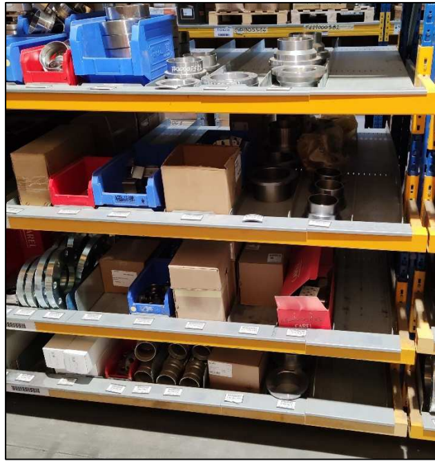
Figura 5.13 Particolare di una campata dopo l'applicazione della seconda "S". Su ciascun ripiano si può notare la presenza del polmone (immagine adattata da fonte interna MEHITS S.p.A.)
