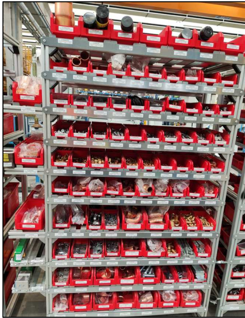
Figura 4.3 Esempio di uno scaffale per la gestione di Kanban a doppio contenitore, utilizzato nelle linee produttive dello stabilimento M12 (immagine adattata da fonte interna MEHITS S.p.A.)
