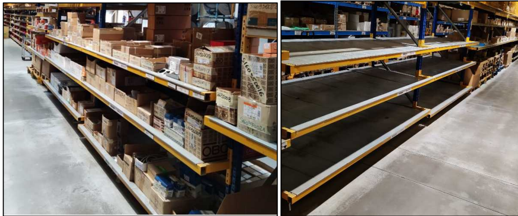
Figura 5.14 Le campate della zona riservata ai codici "speciali": a sinistra la situazione ad inizio progetto e a destra la situazione dopo averle completamente liberate di materiale superfluo e averle pulite durante l'applicazione delle prime tre "S". (immagini adattate da fonte interna MEHITS S.p.A.)
