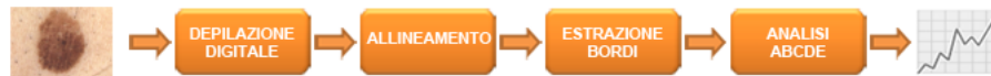
Figura 3.1.7: Dopo l'acquisizione su ogni immagine dermoscópica vengono eseguite le seguenti elaborazioni: depilazione digitale, allineamento rispetto un'immagine riferimento ed in fine l'estrazione dei bordi.
