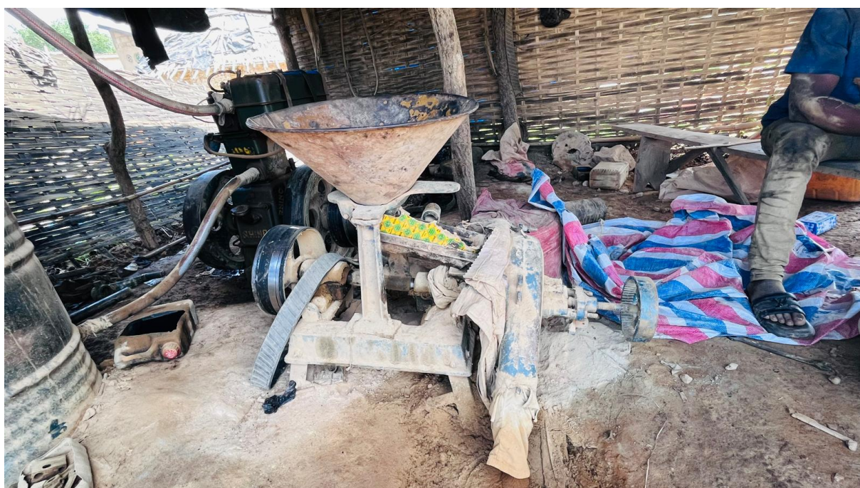
Annexe 4: Le moulin broyeur
