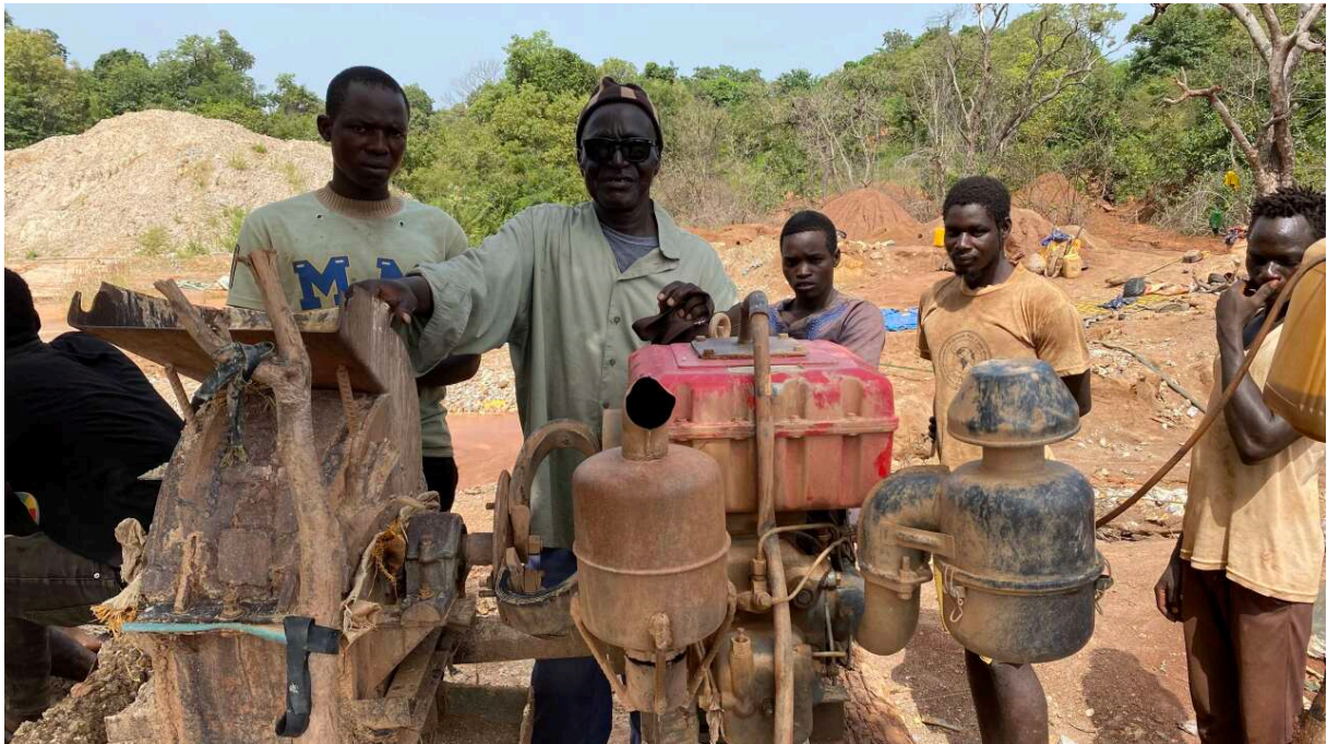
Figure 17: Dembo Singoura avec son équipe d'orpailleurs et le cracheur, qui concasse le minerai à Ngari dans la région de Kédougou en octobre 2023, cliché du journal français courrier international photo prise par Frédéric KOLLER/Le Temps.
