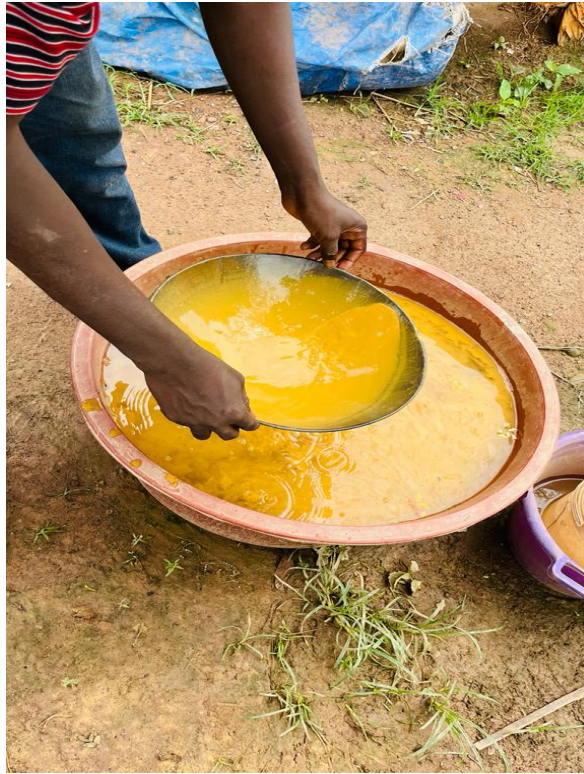
Figure 23: La batée un outil indispensable dans le lavage démontrée par Mamady Cissokho 103 , cliché Boubacar SOUARE août 2023.
