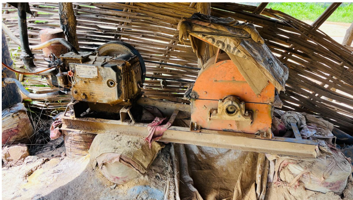
Annexe 3: La machine servant le concassage et le broyage du minerai extrait des mines d'or à Khossanto
