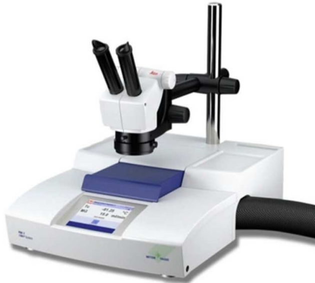
Figura 2.1: Calorimetro flash usato per le misure di C_p . Sotto il microscopio, che serve per il posizionamento dei campioni, si trova una piastra di plastica per l'isolamento luminoso e termico del campione, che viene montato sotto [3].
