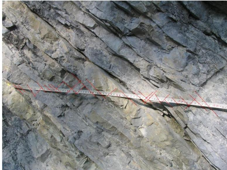
Figura 39 – Linea di scansione in una stazione geomeccanica. In rosso le famiglie di discontinuità che la intersecano.
