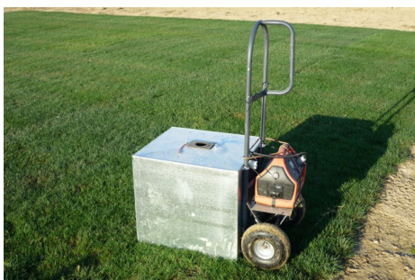
Fig. 1.7 Apparecchiatura per rilevazione del colore tramite fotocamera digitale e luce artificiale.
