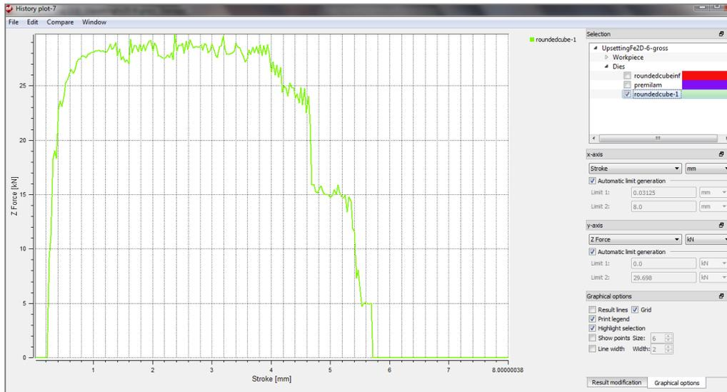
Figura 66: Curva della forza su corsa nel programma Simufact
