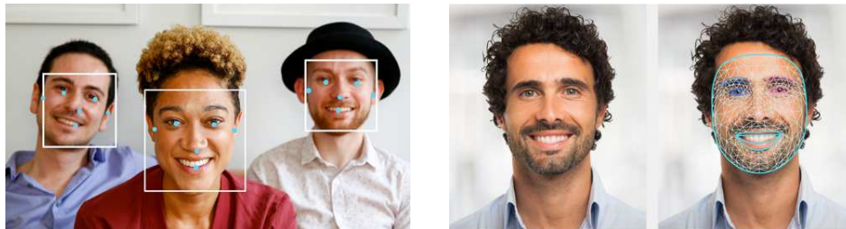
Figura 8: Sulla sinistra un esempio di rilevamento dei volti, sulla destra un esempio di estrazione dei landmark facciali
