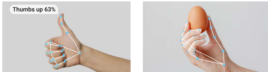
Figura 7: Sulla sinistra un esempio di riconoscimento dei gesti delle mani, sulla destra un esempio di estrazione dei landmark delle mani
