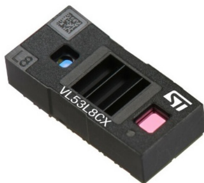
Figura 10. Involucro tipico di un sensore VL53Lxx
