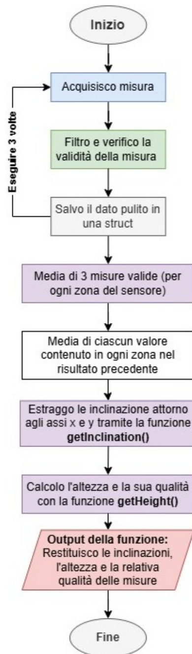
Figura 75. Diagramma di flusso della funzione getResultMeasures
