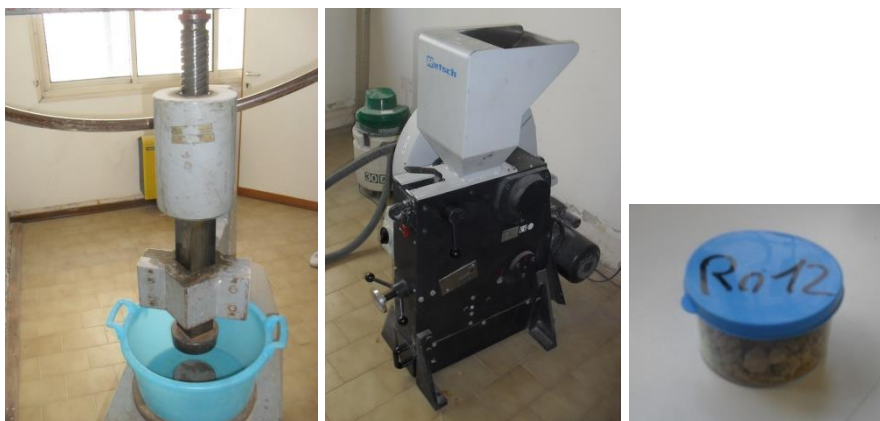
Figure 10, 11 e 12. Frantoio a mano, frantoio a mascelle e granulato pronto per le analisi
