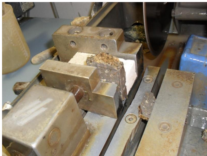
Figura 9. Taglio di una fetta di trachite con sega diamantata
