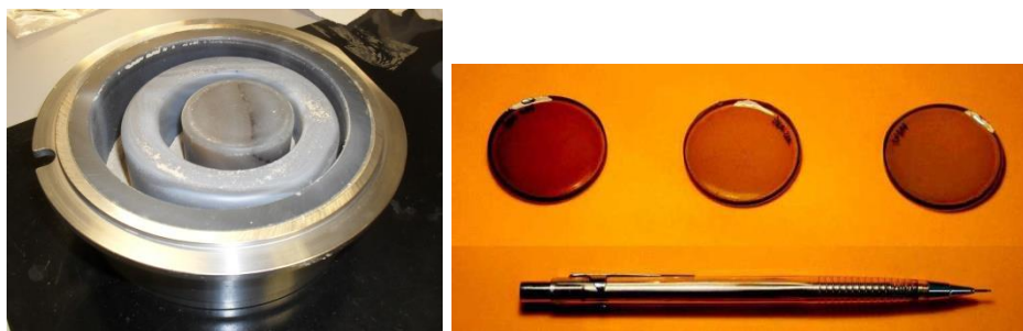
Figure 13 e 14. Mulino a dischi in agata e un esempio di perla vetrificata pronta per le analisi
