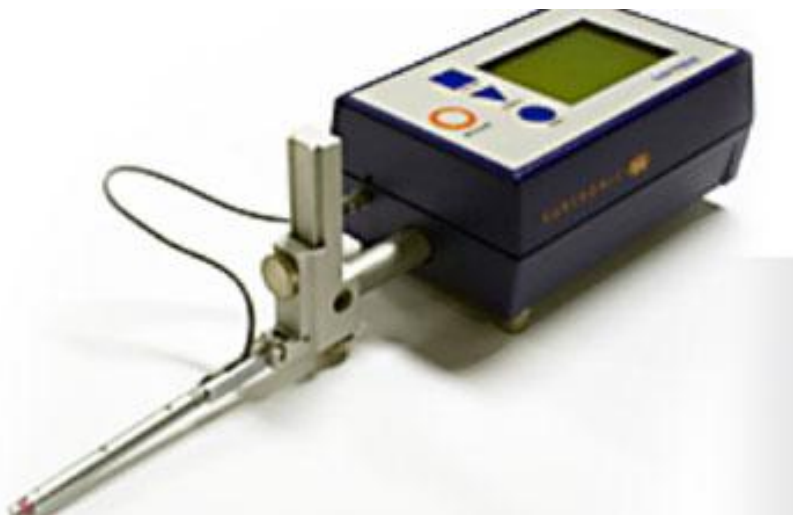
Fig. 3.14. Profilometro Surtronic 25 (Taylor-Hobson) impiegato per la rilevazione del tasso di usura.
