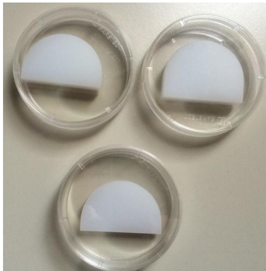
Fig. 3.19. Piatti tibiali in UHMWPE adottati come substrato per i test tribologici e di nanoindentazione.
