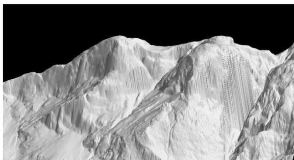
*Figura 11: Il modello LIDAR, si nota la scarsa risoluzione sulle pareti*
