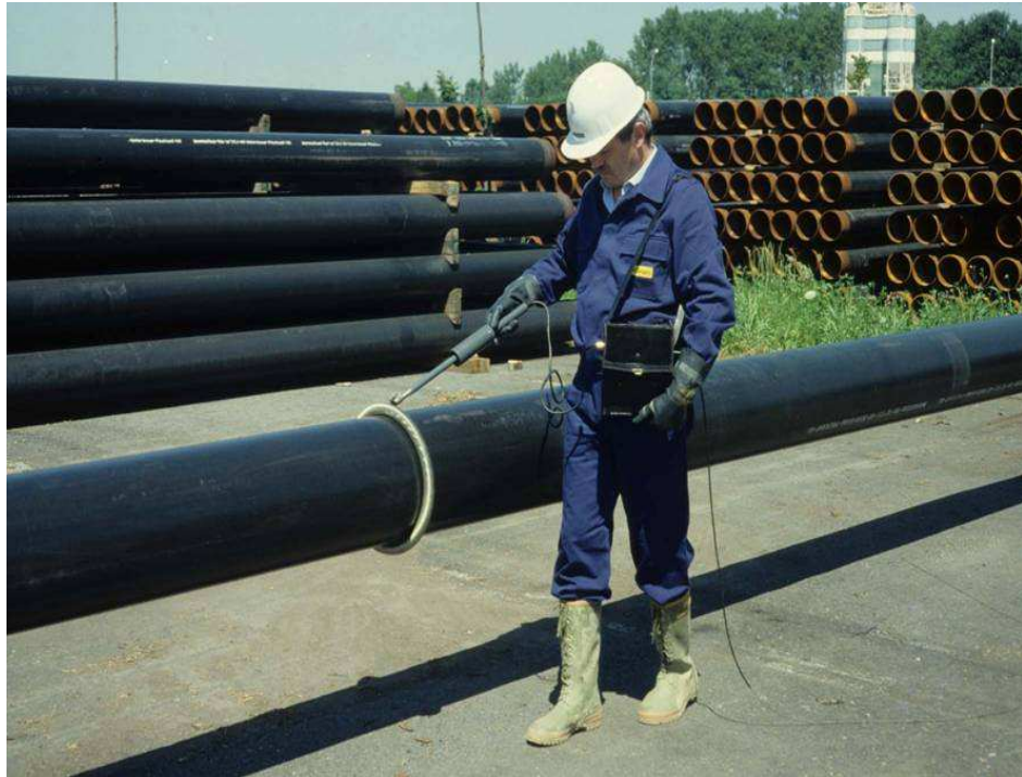
Fig. 3.7. Holiday detector con elettrodo a molla: questo particolare elettrodo permette la verifica totale della superficie del rivestimento delle condotte sospese con un'unica passata
