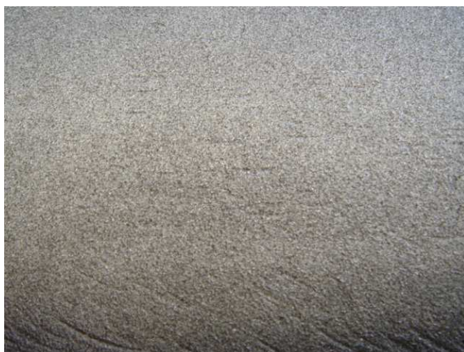
Fig. 3.3. Superficie sabbiata al grado Sa 2 ½ ISO 8501-1
