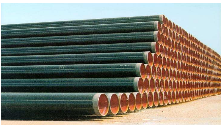
Fig. 3.4. "Parco tubi SRG": barre di tubo rivestite in polietilene: si notano le teste sulle quali il rivestimento verrà applicato in campo dopo la saldatura.
