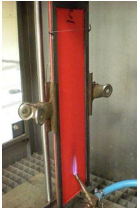
Figura 5.16 Applicazione di piccola fiamma UNI 8457
