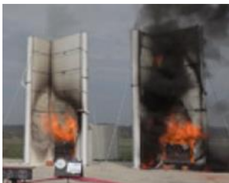
Figura 6.2. Istante della prova fotografato dopo un quarto d'ora dall'inizio del test. A destra il Sistema di facciata 1, a sinistra il 2.
