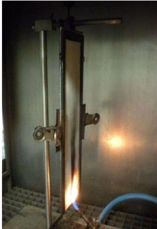
Figura 5.15 Applicazione di piccola fiamma UNI 8456
