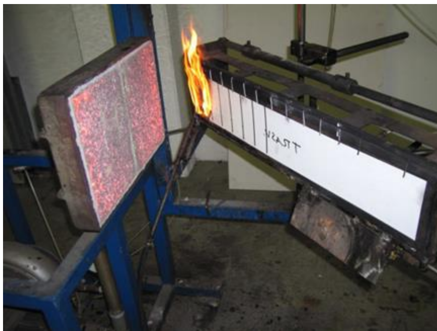
Figura 5.21. Fotografia riportata a titolo esemplificativo di un test di prova secondo la norma UNI 9174
