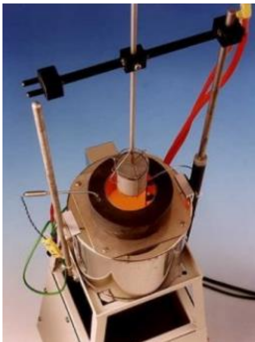
Figura 5.1. Campione cilindrico immesso nel forno conforme alla norma UNI ISO 1182-2010
