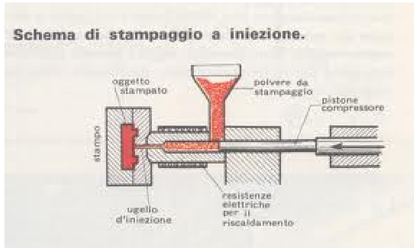
Fig. 4.3 Schema di stampaggio a iniezione
