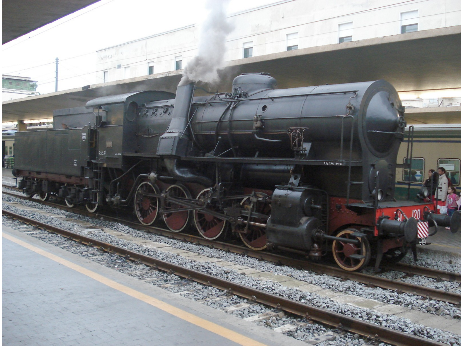
Locomotiva Gr 741 Trasformata con sistema Franco-Crosti
