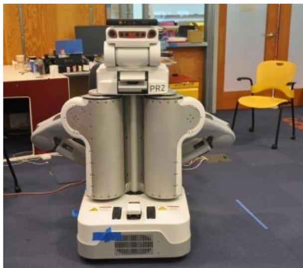
**Fig. 18** Robot sviluppato da John J. Leonard in collaborazione con Hordur Johannsson. Il sistema è in grado di muoversi all'interno di uno spazio in continua evoluzione grazie alla creazione di una mappa tridimensionale mediante l'utilizzo di Microsoft *Kinect* [54]
