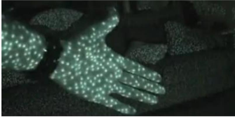
**Fig. 2** Esempio di proiezione di pattern 2D generato da microsoft Kinect. [47]
