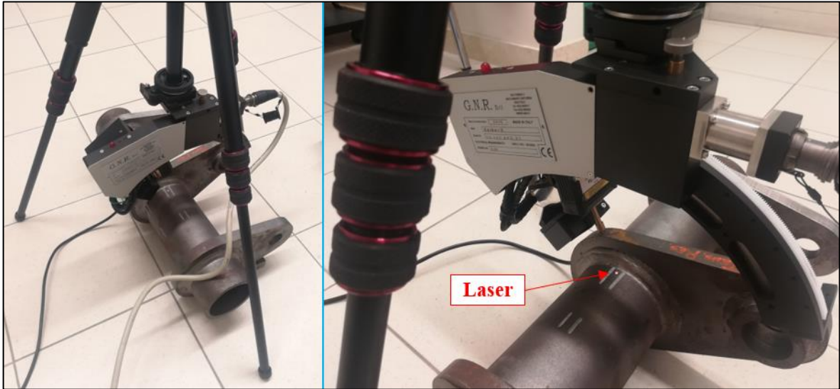
Fig. 2.21: Esempio di misurazione tramite Spider X sul Path 0^\circ di un provino. In figura è indicato il laser che permette un accurato posizionamento del diffrattometro nel punto da analizzare.
