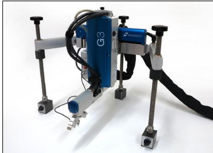
Fig. 2.18: Stresstech G3 utilizzata all'università di Friburgo [56].
