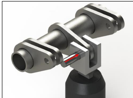
Fig. 3.3: Rappresentazione del montaggio relativo al perno centrale per il provino a 5 piastre [56].
