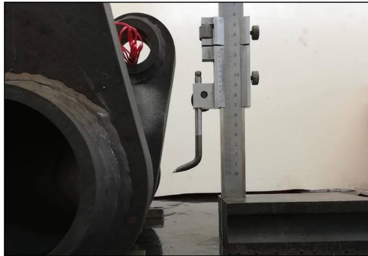
Fig. 5.40: Truschino utilizzato per la tracciatura delle linee per il posizionamento degli estensimetri.
