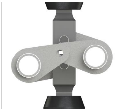
Fig. 3.6: Rappresentazione delle posizioni teoriche dei provini dopo l'inserimento dei rispettivi perni centrali [56].
