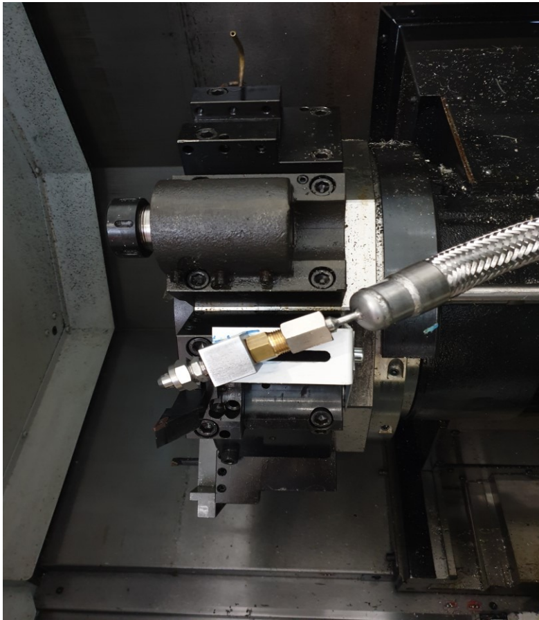
Fig.3. Set-up criogenico migliorato: ugelli della serie BR/BU con riduzione in ottone
