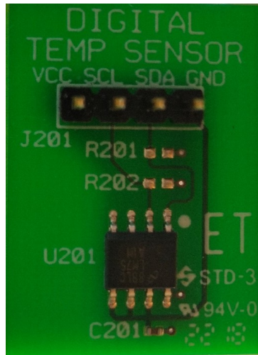
Figura 5.3: Collegamenti dei pin A0, A1 ed A2 che sono i 3 in basso a sx.
