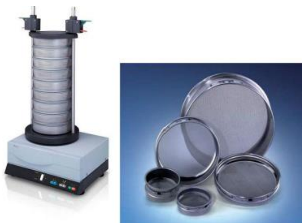
Figura 2.1: A sinistra vibrovaglio Retsch As 200 control; a destra setacci per vibrovaglio.
