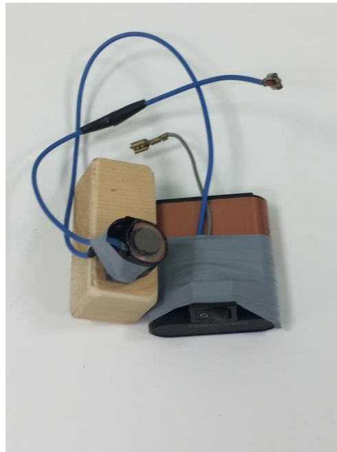
Figura 2.6: Elettrocalamita costruita per le prove sperimentali.
