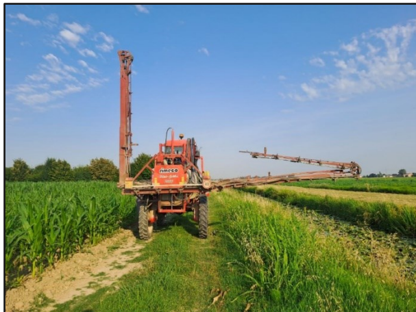
Fig. 21 Irroratrice semovente Mod.Rimeco Mini-Colibri 1000
