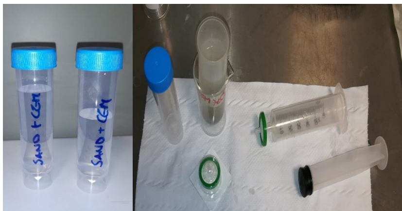
Figura 2.26: Nella figura a sinistra si osserva l'eluato pronto per essere analizzato, invece a destra si può osservare la provetta contenente il liquido da separare, una provetta vuota per inserire l'eluato ed una siringa per poter effettuare il filtraggio del liquido.
