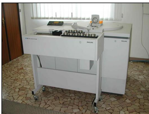
Figura 2.15: Spettrometro sequenziale WDS Philips PW2400 presente nel laboratorio di spettrometria XRF nel dipartimento di Geoscienze dell'università degli studi di Padova [47].
