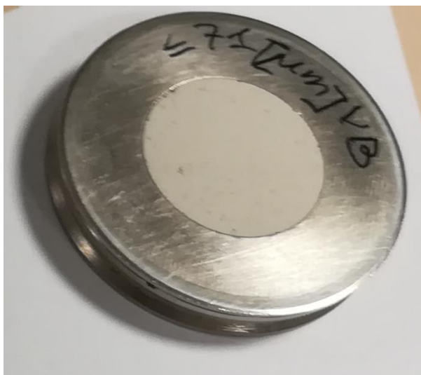
Figura 2.20: Campione di scoria Valbruna con granulometria inferiore-uguale a 71 \mu\text{m} . Il campione è stato preparato per un'analisi qualitativa. Esso è sito all'interno di un portacampione da 27mm utilizzando la tecnica della retrocarica.
