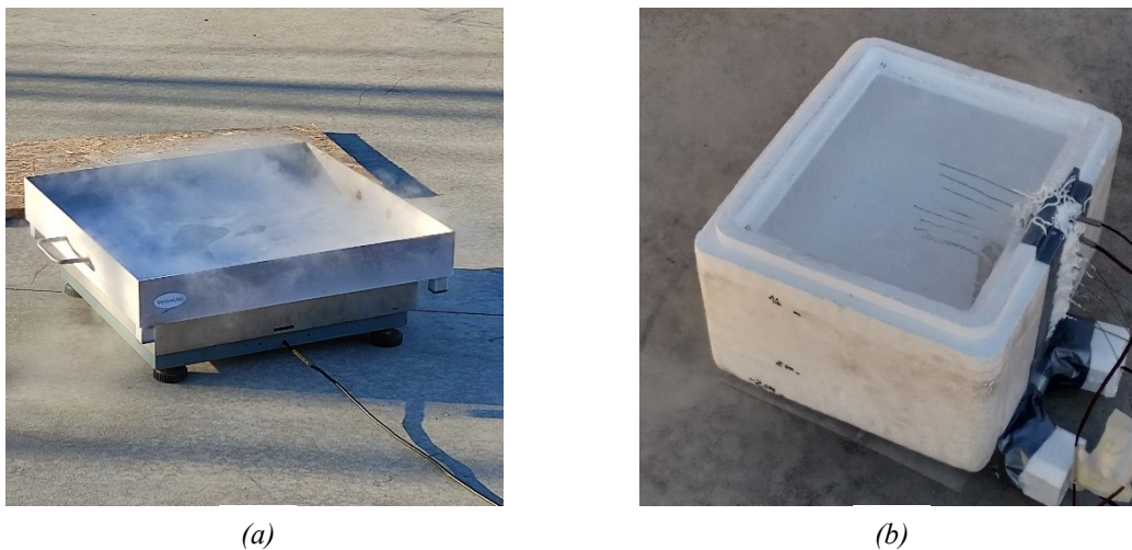
Figura II.1. (a) Ghiotta in acciaio, posizionata sulla cella di carico. (b) Box in polistirolo, dotato di termocoppie.
