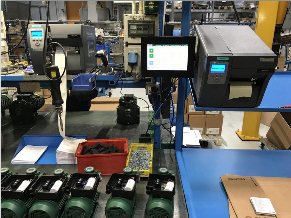
*Figura 3.17 – Postazione di assemblaggio della linea pilota con tablet per stampa delle etichette dati e imballaggio.*
