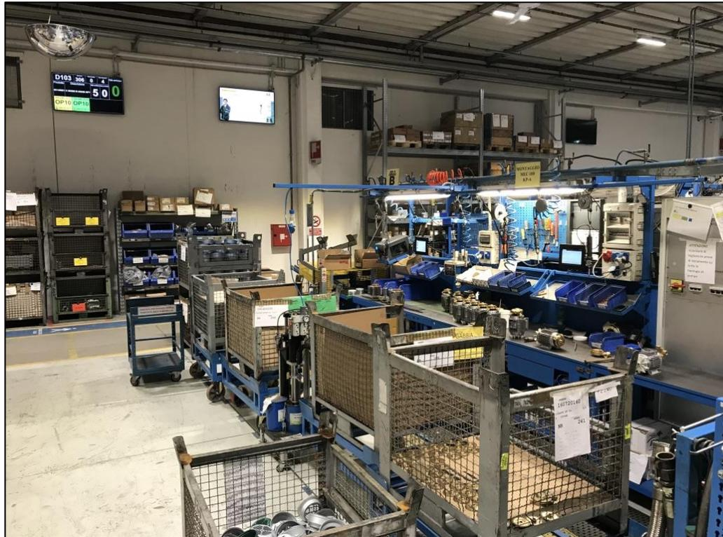
*Figura 3.12 – Linea pilota dopo l’installazione dei tablet e dei display andon.*
