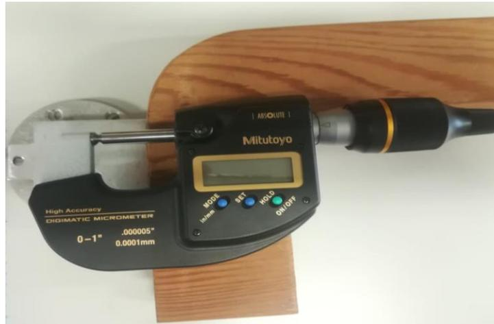
**Figura 4.4.** Foto del micrometro digitale Mitutoyo Multimeter
