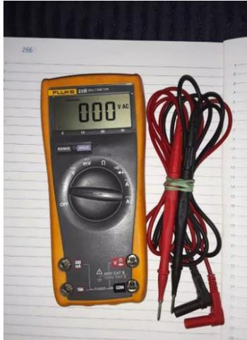
**Figura 4.2.** Foto del Fluke 23 III Multimeter
