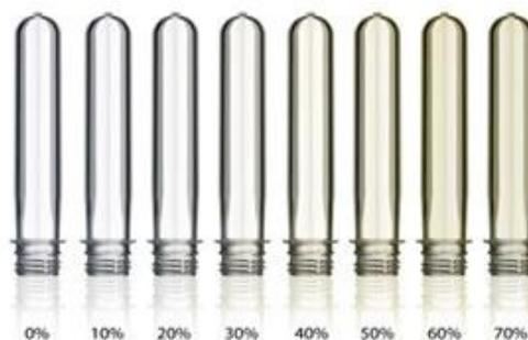
**Figura 3.4.** *colorazione delle preforme all'aumentare della percentuale di R-PET*
