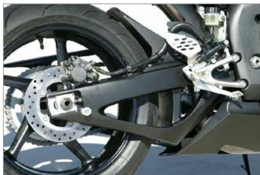
Figura 2.4: Capriata di rinforzo inferiore del forcellone della Yamaha R1. Immagine tratta da dueruote.it.
