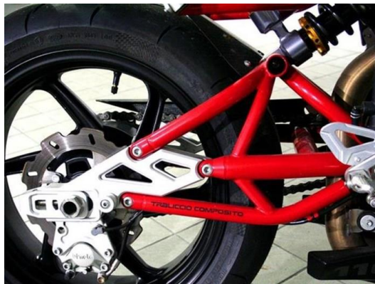
Figura 2.2: Forcellone misto della Bimota DB5. Immagine tratta da moto.it.
