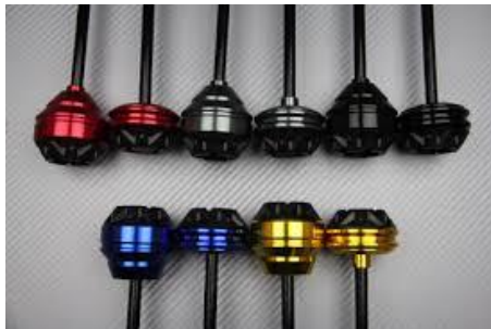
Figura 2.8: Tamponi per forcella anteriore e forcellone. Immagine tratta da avdb-moto.fr .
