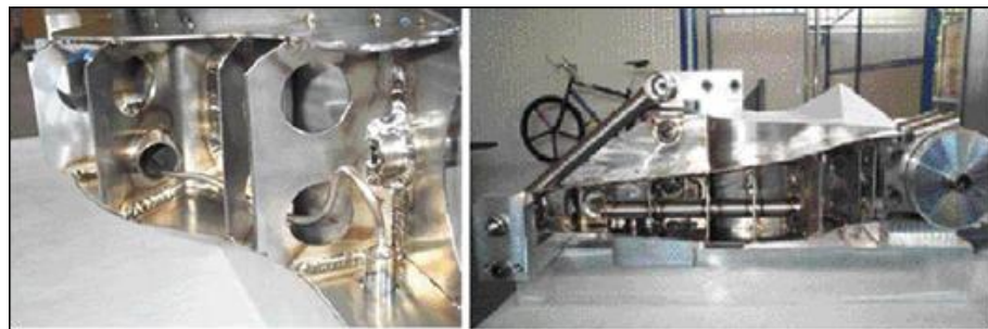
Figura 2.6: Forcellone scatolato in titanio per la MV Agusta F4 in fase di lavorazione nelle officine Poggipolini. Sulla destra si può notare il tubo che attraversa longitudinalmente tutta la struttura. Immagine tratta da ing.unitn.it.
