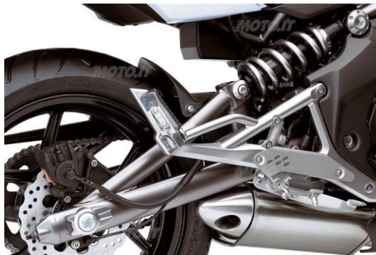
Figura 3.3: Mono-ammortizzatore in posizione decentrata sulla Kawasaki ER-6n . Immagine tratta da moto.it .
