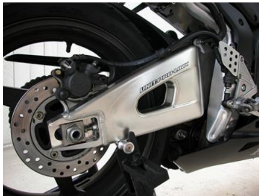
Figura 2.1: Esempio di forcellone stampato. Immagine tratta da wikipedia.it.
