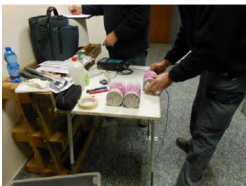
Figura 3.4.1. Esecuzione di prove ultrasoniche su carote
