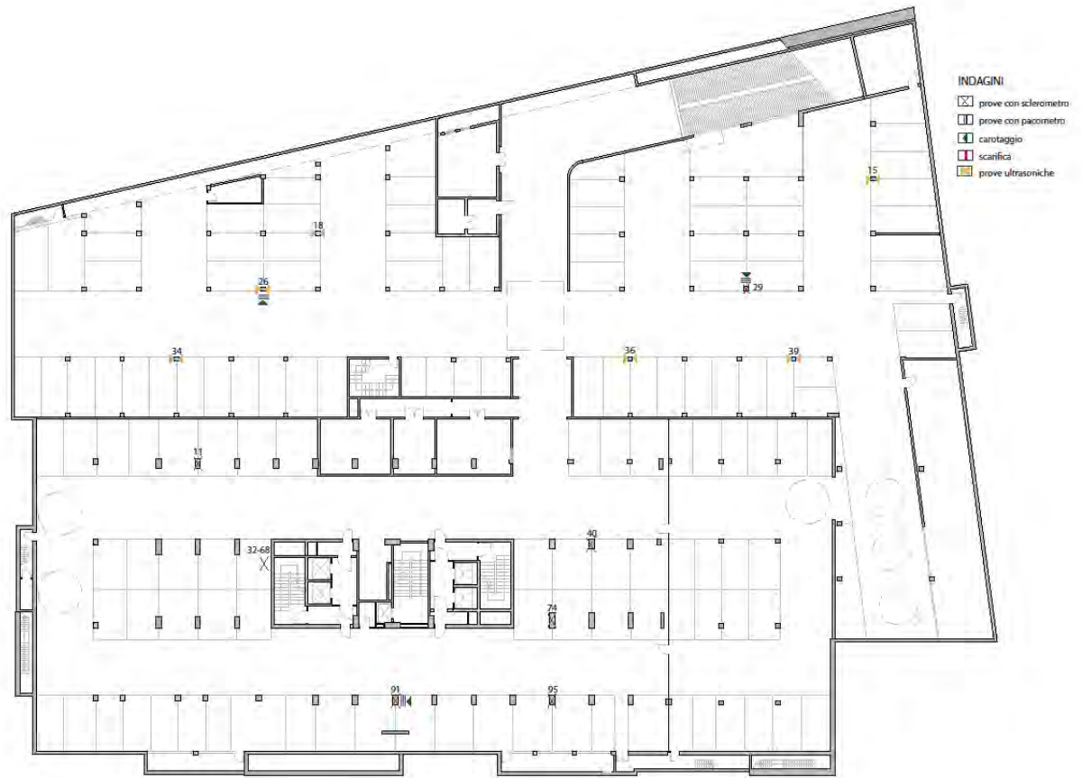
Figura 3.2. Piano d'indagini, pianta primo interrato
