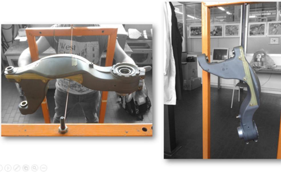
Figura 4.5: Determinazione della posizione del baricentro
