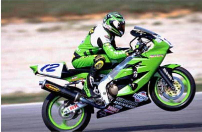
Figura 1.4: Trasferimento del carico in accelerazione
