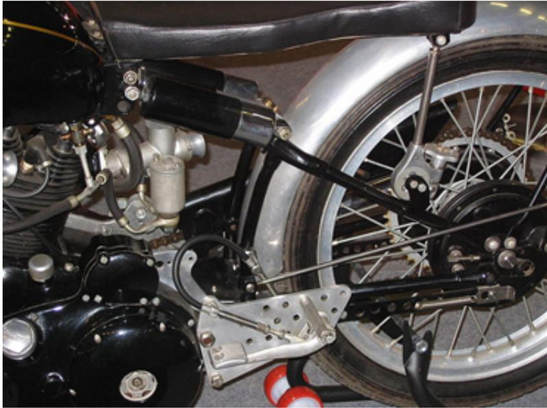
Figura 2.5: Sistema Cantilever
