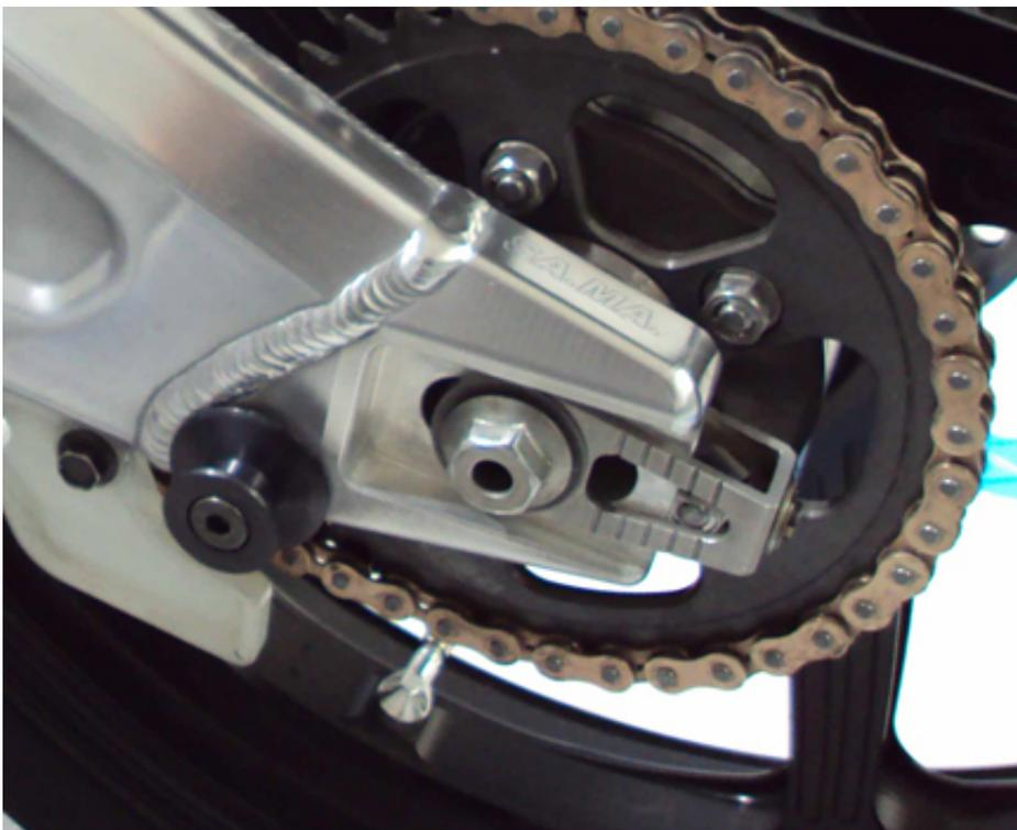
Figura 2.6: Sistema di regolazione a vite e piastra
