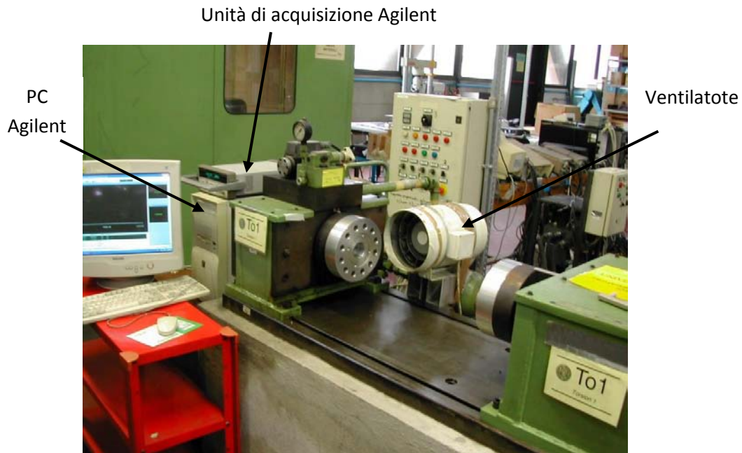
Figura 5.2.1a Attrezzature necessarie per l'esecuzione delle prove
