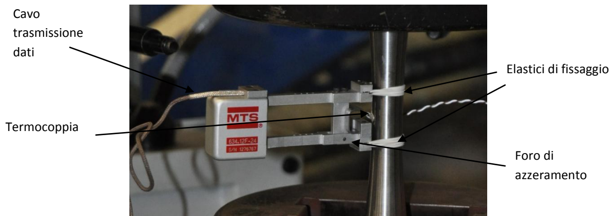
Figura 2.6.6a Montaggio estensometro assiale
