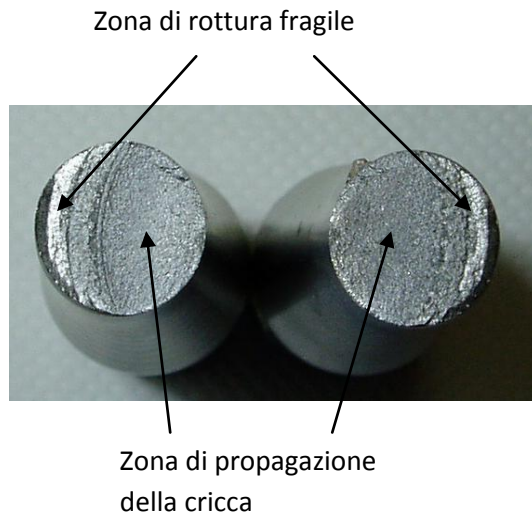
Figura3.2.1e Esempio tipico di superfici di frattura (provino Traz_liscio_R-1_07 \sigma_a=335\text{MPa} ; Nf = 123424)
