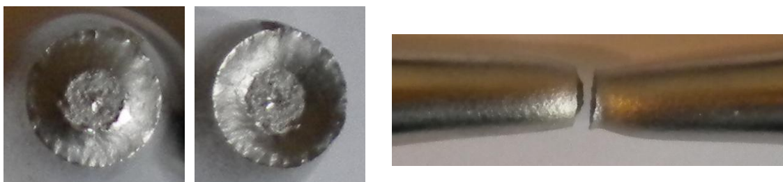
Figura 2.2e Immagini della superficie di frattura statica e della zona di strizione
