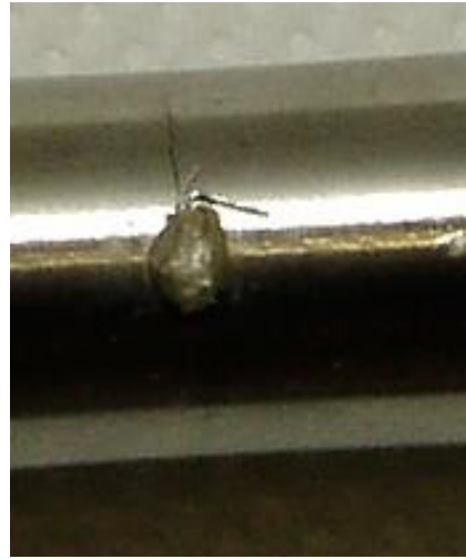
Figura A13.6 Vista laterale e vista frontale della cricca per il provino Traz_liscio_R-1_13
