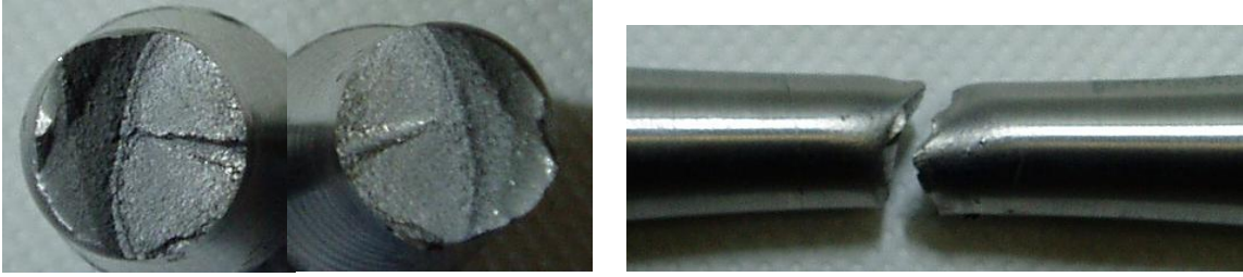
Figura A4.3 Superfici di frattura e vista laterale per il provino Traz_liscio_R-1_04
