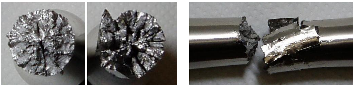
Figura C6.4 Vista frontale e vista laterale delle superfici di frattura per il provino Torq_liscio_R-1_06
