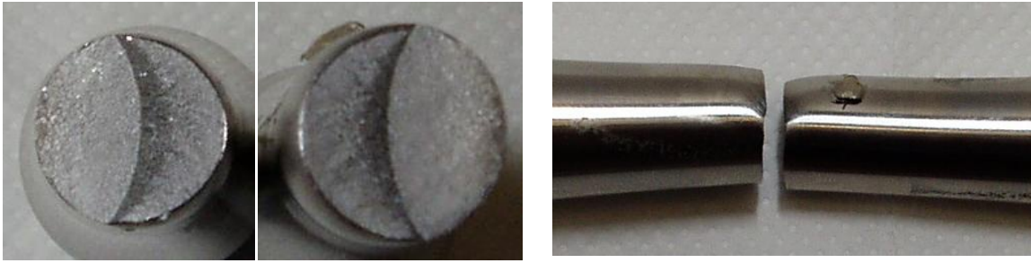
Figura A8.5 Superfici di frattura e vista laterale per il provino Traz_liscio_R-1_08
