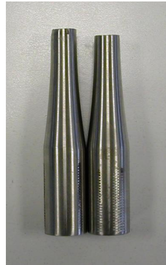
Figura3.2.1e Esempio tipico di superfici di frattura (provino Traz_liscio_R-1_07 \sigma_a=335\text{MPa} ; Nf = 123424)
