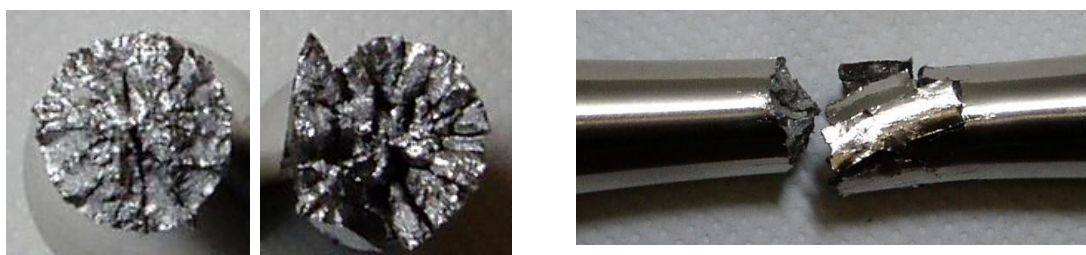
Figura 6.2.1f Esempio tipico di superfici di frattura (provino Torq_liscio_R-1_06 \tau_a=350\text{MPa} ; Nf = 7235) nelle prove a rapporto di ciclo R-1
