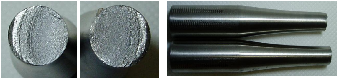
Figura A7.5 Superfici di frattura e vista laterale per il provino Traz_liscio_R-1_07
