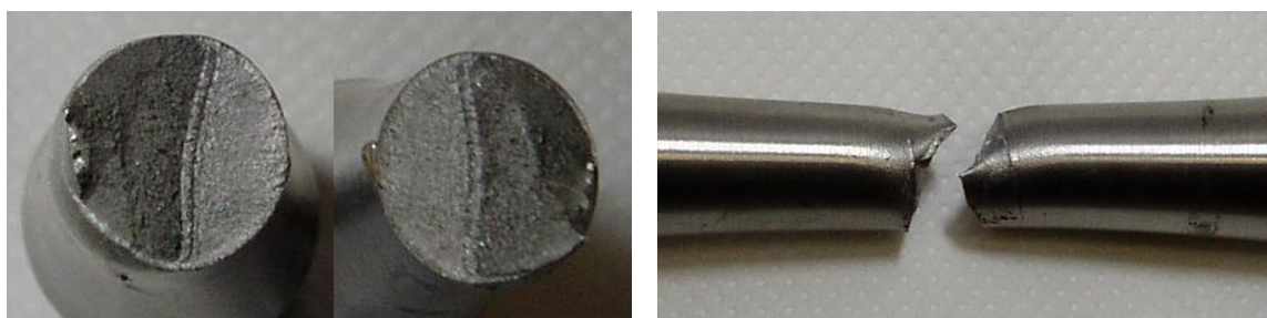
Figura A3.1 Superfici di frattura e vista laterale per il provino Traz_liscio_R-1_03
