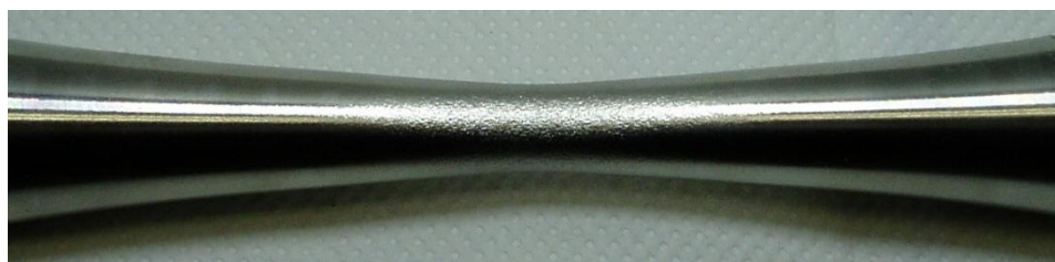
Figura B13.4 Vista della strizione e della plasticizzazione della sezione minima per il provino Traz_liscio_R0,1_13
