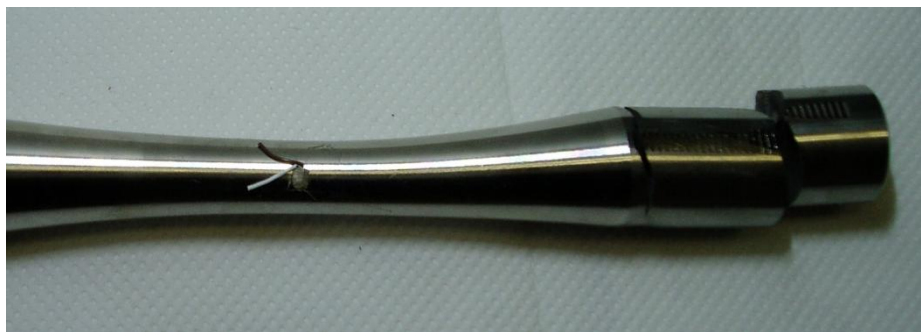
Figura B7.2 Vista della rottura dell'afferraggio causa della sospensione della prova per il provino Traz_liscio_R0,1_07
