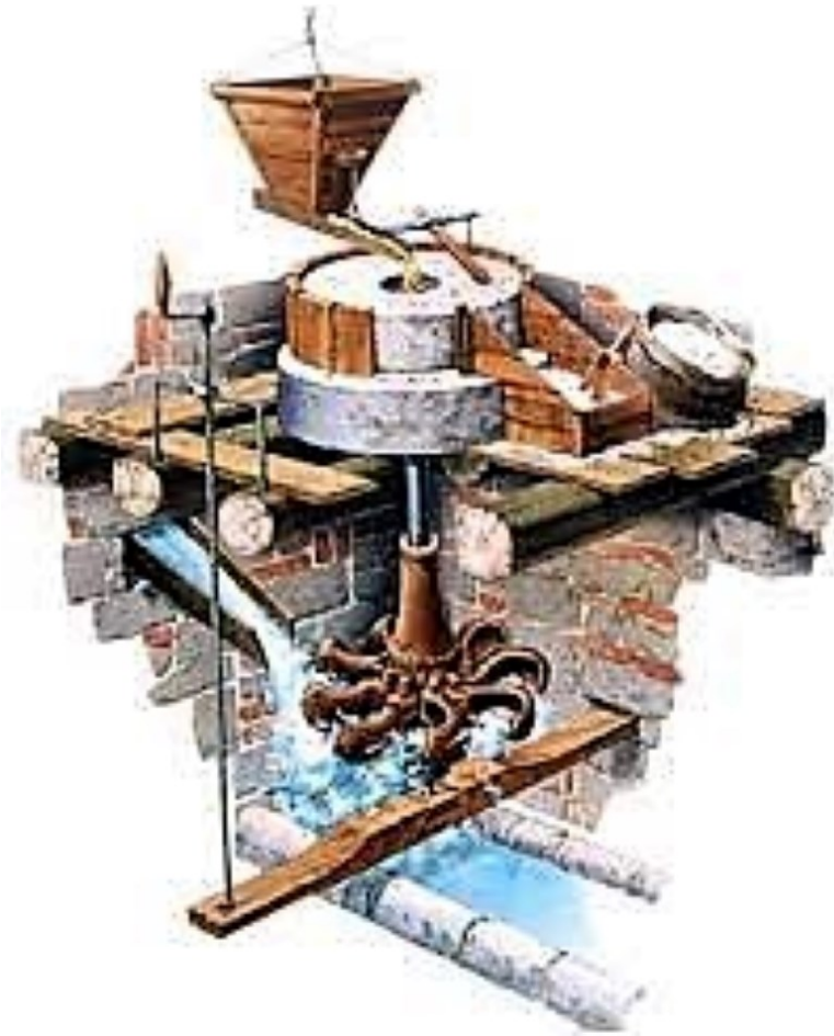
Figura 11. Schema del funzionamento di un mulino idraulico a ruota orizzontale. Fonte: https://www.cascatedichia.it/2022/06/27/come-funzionavano-i-mulini-ad-acqua-lungo-il-fosso-castello/
