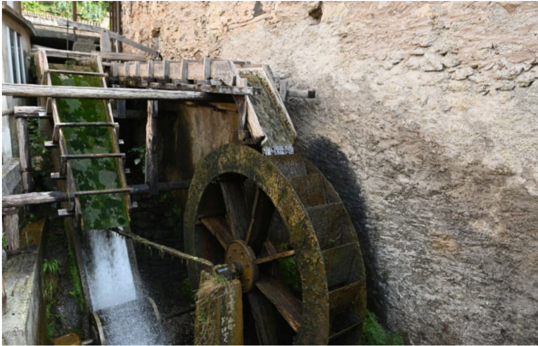
Figura 30. La ruota a coppedello che alimentava la sega veneziana. Fonte: https://www.magicoveneto.it/pasubio/ValliPasubio/Via-dell-Acqua-Valli-del-Pasubio.htm
