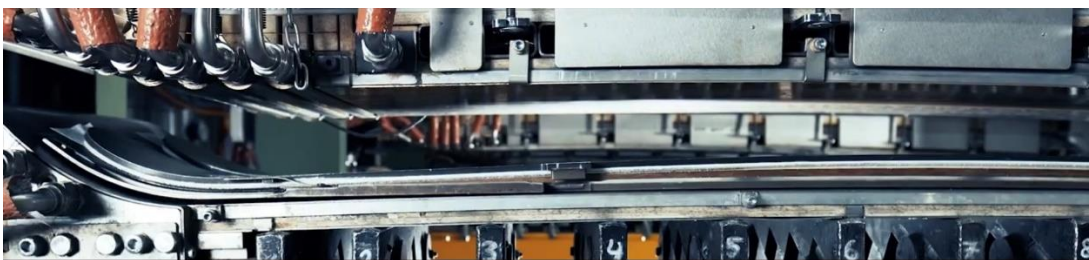
Figura 3.4: Pressa utilizzata per la compattazione e l'incollaggio dei vari strati dello sci. [14]
