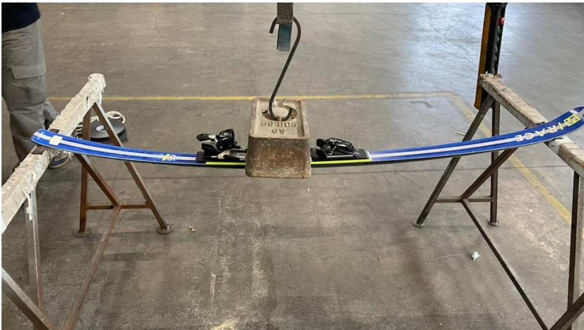
Figura 4.2: Immagine raffigurante lo sci caricato con la massa da 50kg.
