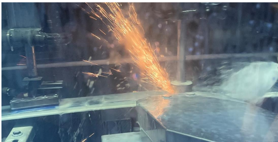
Figura 3.6: Operazione di finitura delle lamine dello sci.
