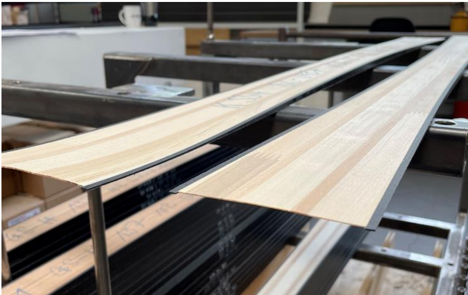
Figura 3.1: Core in legno dopo operazione di taglio e incollaggio dei fianchetti.
