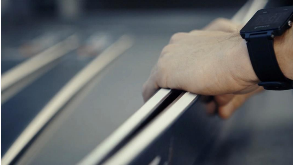
Figura 3.5: Operazione di verifica dell'appaiamento di due sci in base al camber. [14]
