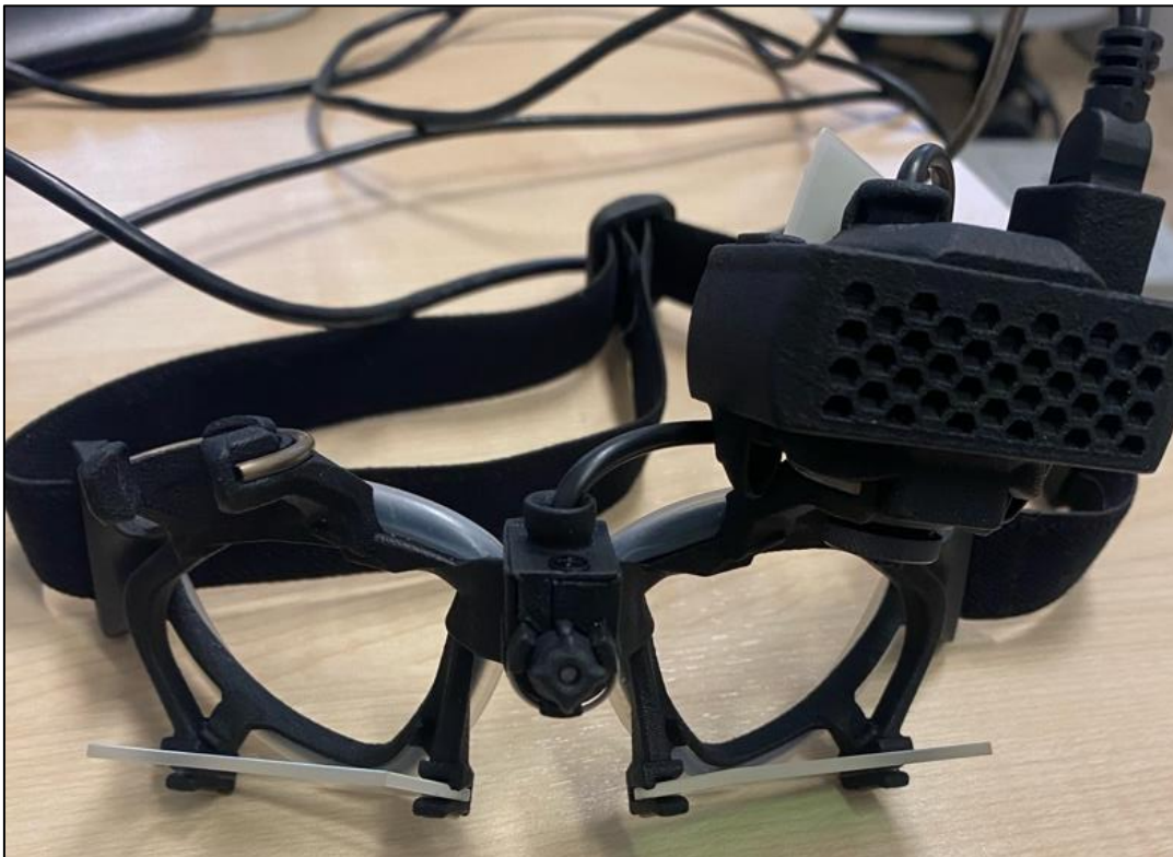
Figura 8. Maschera indossabile con telecamera infrarosso
