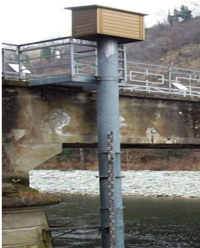
*Figura 4: vista esterna idrometrografo a galleggiante*
