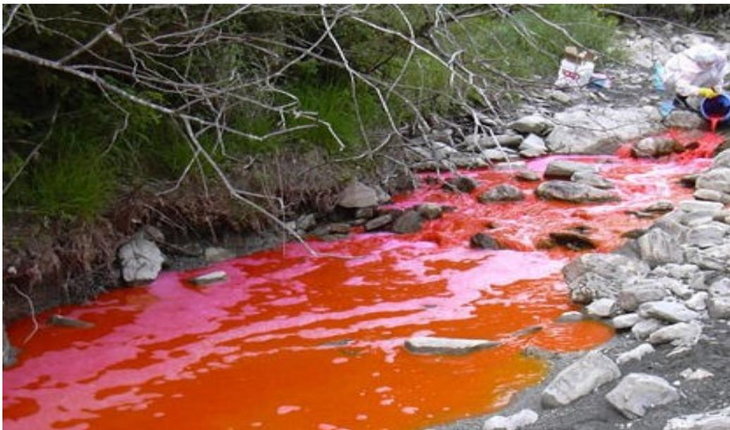
*Figura 2: immagine di tracciante fosforescente per ricavare la portata idrica*
