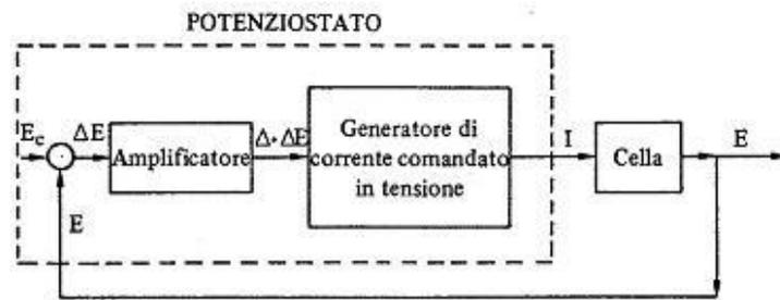
Figura 2.1 : schema a blocchi di un potenziostato
