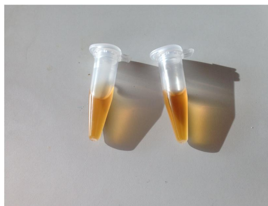
Fig. 5.6: Preparazione del campione: le due aliquote da 0,5 ml di un campione che saranno poi osservate al microscopio.
