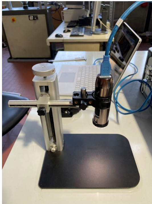
Figura 5.2.3: Microscopio "Dino – Lite Edge 3.0" digitale utilizzato per i rilievi dei provini saldati.
