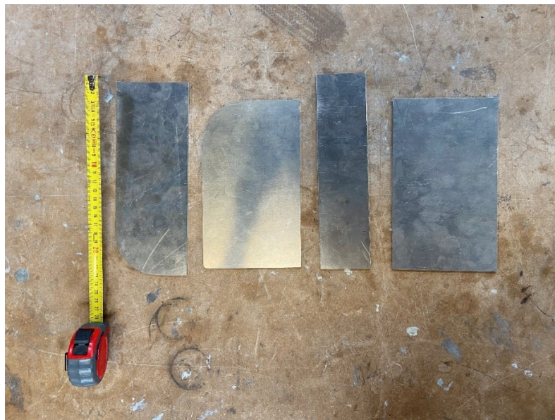
Figura 5.2.1: Provini di Alluminio 6061 T6, spessore 3mm, utilizzati per le prove di saldatura.
