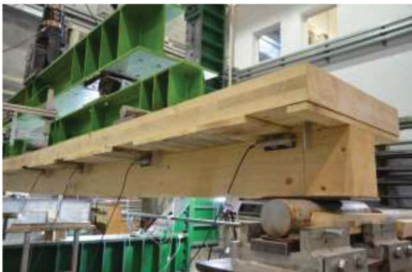
Figura 37 - Fase di assemblaggio: strumentazione
