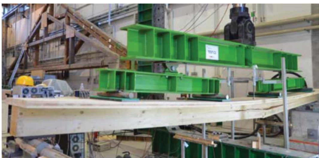
Figura 39 - Fase di carico: prova a flessione su sei punti (Soluzione C)
