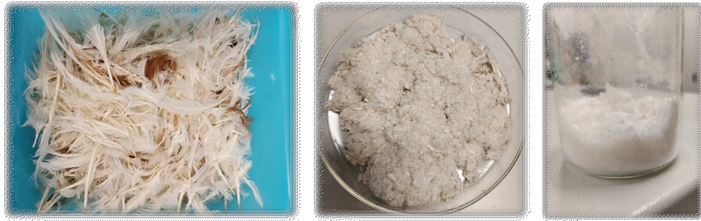
Figura 3.2: Processo di estrazione della cheratina a partire dalle piume di pollo.
