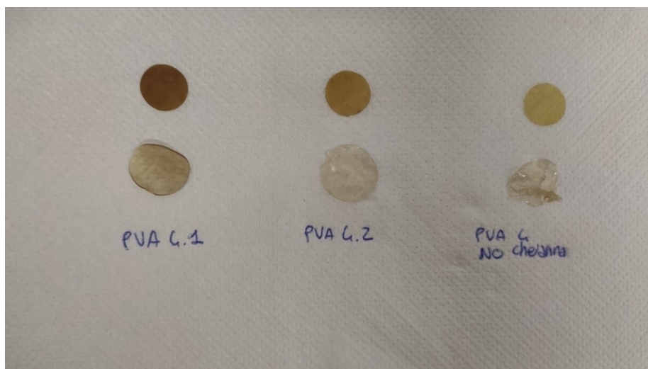
Figura 4.19: Esempio della differenza tra i dischetti primadell'analisi del grado igroscopico rispetto all'acqua e dopo 48 ore immerse in un volume di sei volte superiore al peso dei dischetti.
