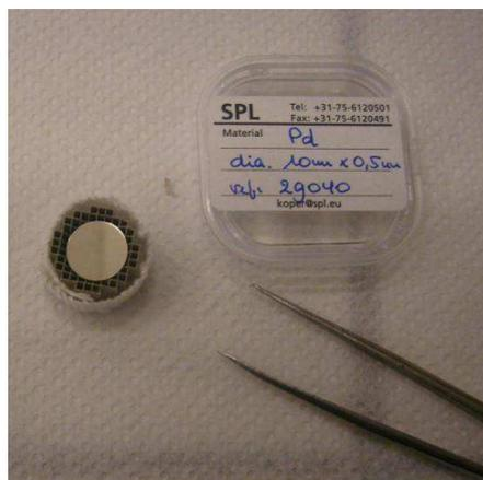
**Figura 4.5.** Monolite con il dischetto di catalizzatore posizionato sopra. La lana di quarzo avvolge il supporto e fa tenuta contro le pareti del tubo in quarzo
