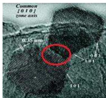
**Figura 3.3.** Esempio di difetto dovuto alla presenza del bordo di grano
