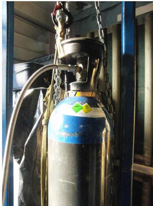
Figura 3.2: Bombola di N_2O con linee di adduzione.
