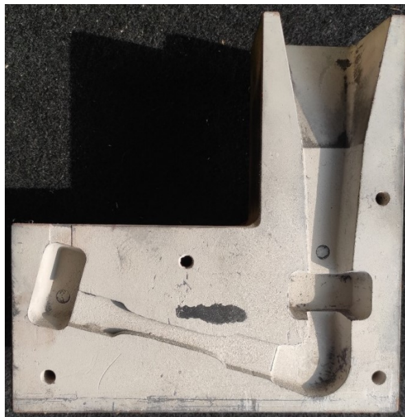
Figura 2.1: Stampo a conchiglia per la produzione di provini piatti
