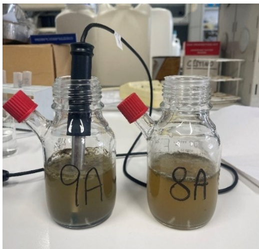
Immagine 13. pH-metro all'interno della singola giara
