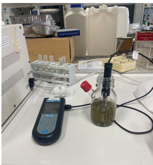
Immagine 14. pH-metro con elettrodo all'interno della giara
