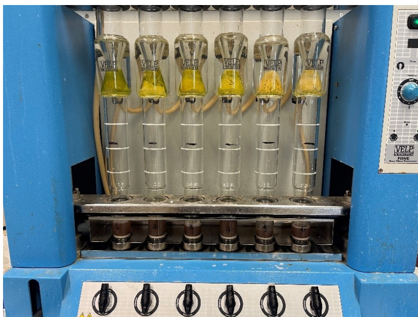
Immagine 16. Gooch fissati nel sistema Fibertech
