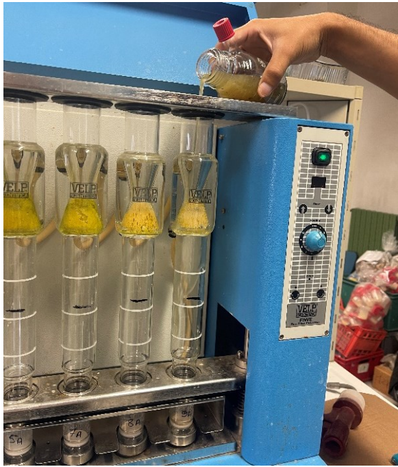
Immagine 18. Liquido che non supera il livello massimo del gooch
