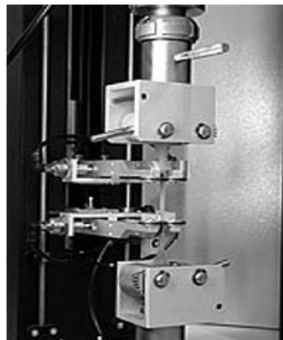
Fig 2.11 : Esempio di estensimetro
