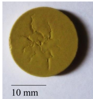
Figura 4.10 Sinterizzato smaltato a 850^{\circ}C con composizione 80% fritta e 20% borosilicato
