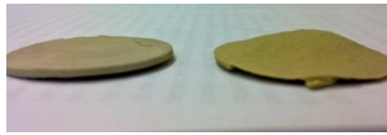
Figura 3.8 A sinistra campione con miscela A, a destra campione con 5% di fritta in bulk
