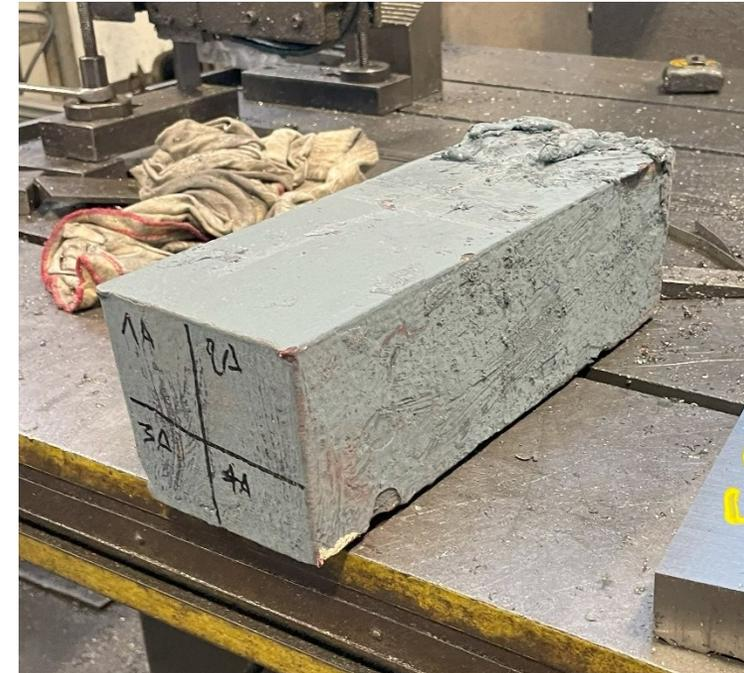
I provini normalizzati, temprati e rinvenuti, sono poi stati portati in officina per ottenere provini normati e poter eseguire le prove meccaniche di resilienza (norme ASTM E23 e ISO 148-1) e di trazione (norma UNI EN 10002/1).
